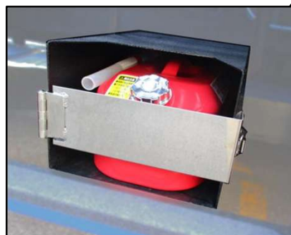
□床下に格納箱を設置
